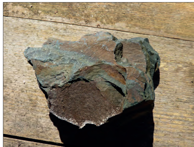
Obr. 15. Masivní zelená chloritová ruda (důl Schlögel). Fig. 15. Massive green chlorite ore (Schlögel Mine).
