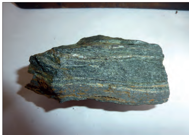
Obr. 14. Kontakt zelené chloritové rudy s magnetitem a šedohnědé magnetitové rudy (důl Rochus). Fig. 14. Contact of green chlorite ore with magnetite, and grey-brown magnetite ore (Rochus Mine).
