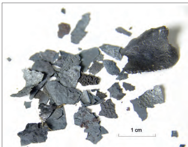
Obr. 14. Příklad recentních plátkových okují vzniklých u stánku uměleckého kováře.
