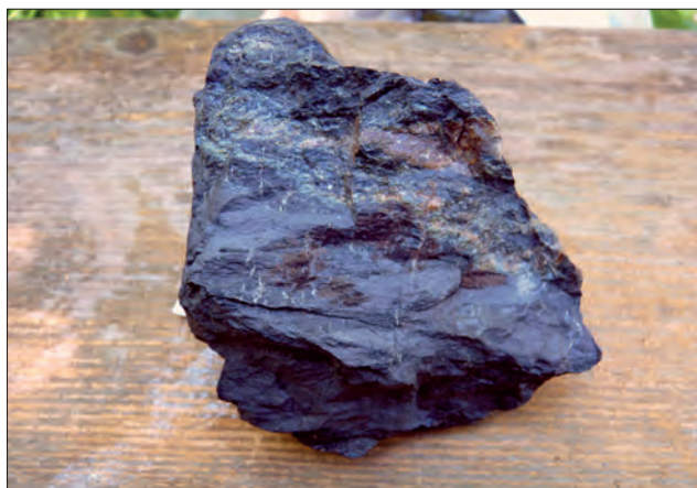
Obr. 8. Hnědý masivní hematit s žilkami pyritu (důl Schützen). Fig. 8. Brown massive hematite with pyrite veins (Schützen Mine).
