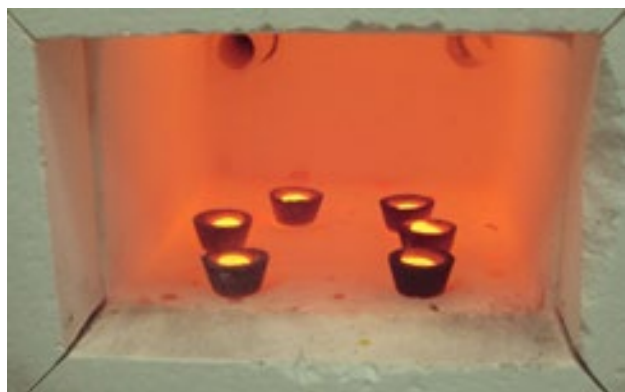
Obr. 6. Průběh kupelace v muflové peci – hoření olova. Foto autoři.
