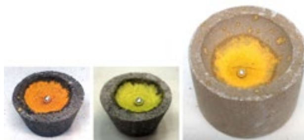
Obr. 7. Kapelky po provedené kupelaci. Kapelka ze směsi neplaveného dřevěného a kostního popela (č. 1, vlevo), kapelka ze směsi plaveného dřevěného a kostního popela (č. 2, uprostřed) a kapelka ze směsi cementu a kostního popela (vpravo) po kupelaci. Foto autoři.
