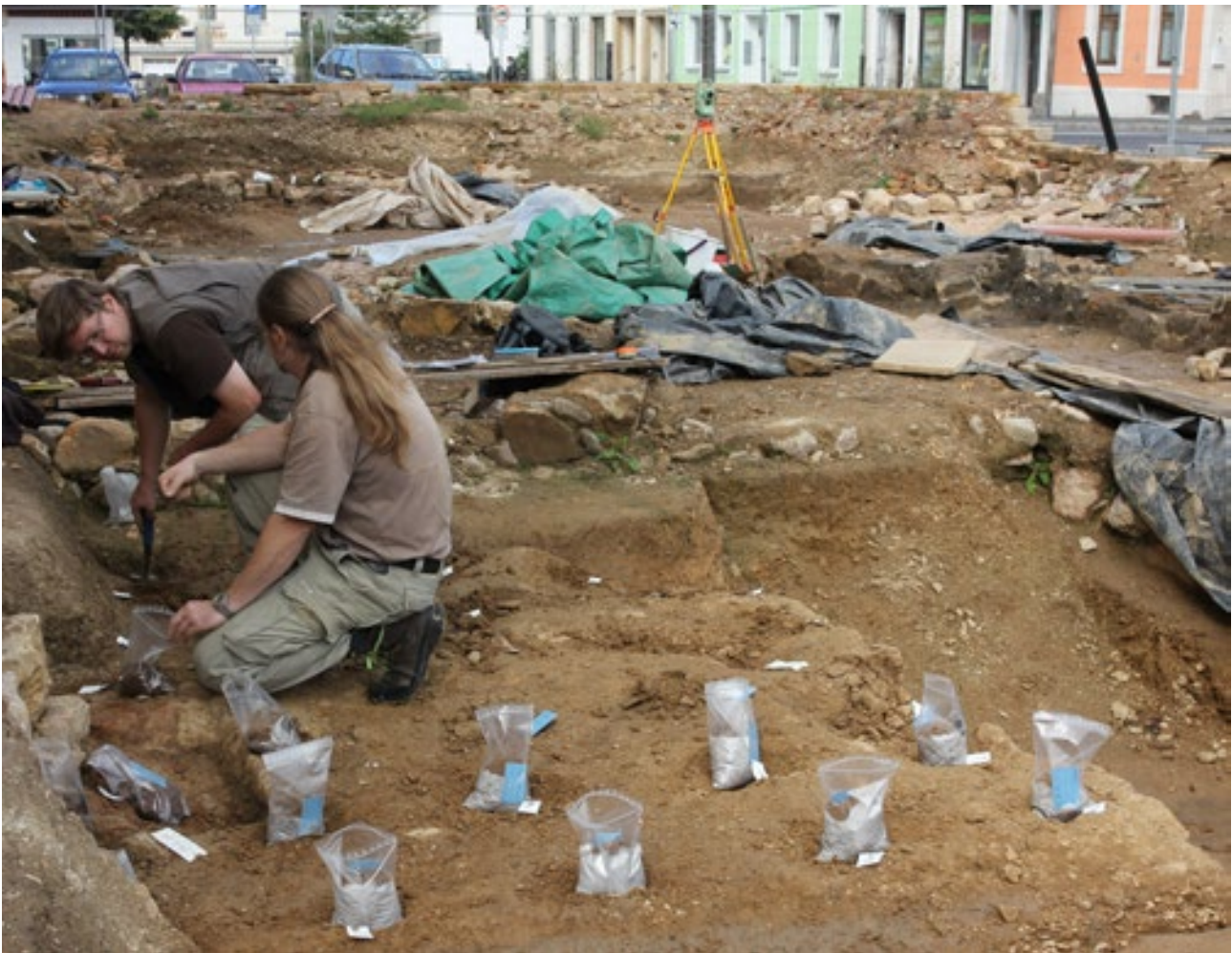
Abb. 5. Entnahme eines regemäßigen Probenrasters zur geochemischen Analyse im Grabungsareal Dippoldiswalde „Roter Hirsch“. (LfA) Obr. 5. Odebírání vzorků pro geochemickou analýzu na nalezišti Dippoldiswalde „Roter Hirsch“. (LfA)
