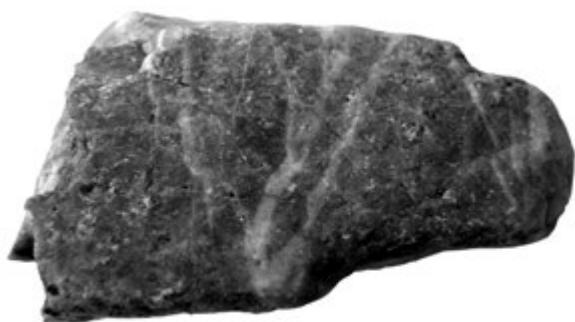
Obr. 8. Kvarcít s hojnými žilkami zlatonosného křemene. Foto E. Houzarová.
